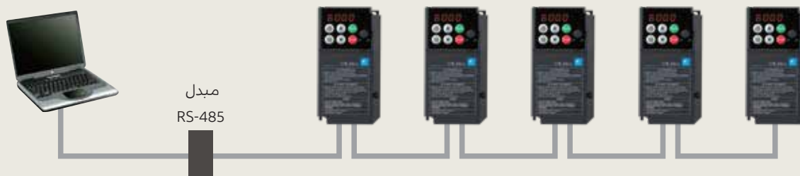
قابلیت ارتباط با چندین درایو توسط کامپیوتر و یا سایر تجهیزات کنترلی توسط شبکه Modbus-RTU
