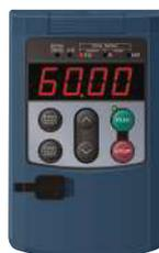
Peut être déconnecté du variateur et utilisé de façon autonome, en connectant le clavier à l'ordinateur équipé avec le logiciel de configuration (en utilisant la connexion USB), afin de vérifier les données sauvegardées dans la console de programmation (bureau).
