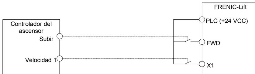
Figura 6: Conexión típica utilizando contactos libres de potencial del controlador del ascensor.
