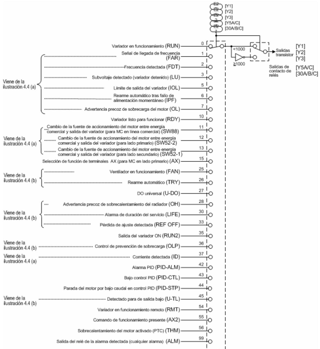
Nota: Las cifras indicadas en los interruptores E20, E21, E22, E24 y E27 corresponden a los datos del código de función expresados en el sistema de lógica normal (activo ON).
