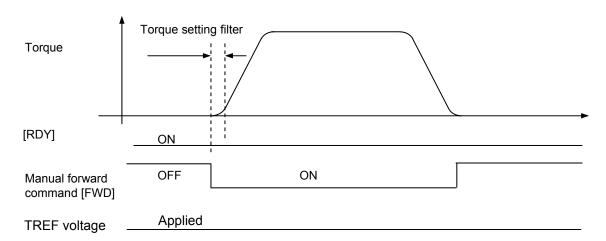
Use parameter PA1\_60 to specify the torque setting filter.
